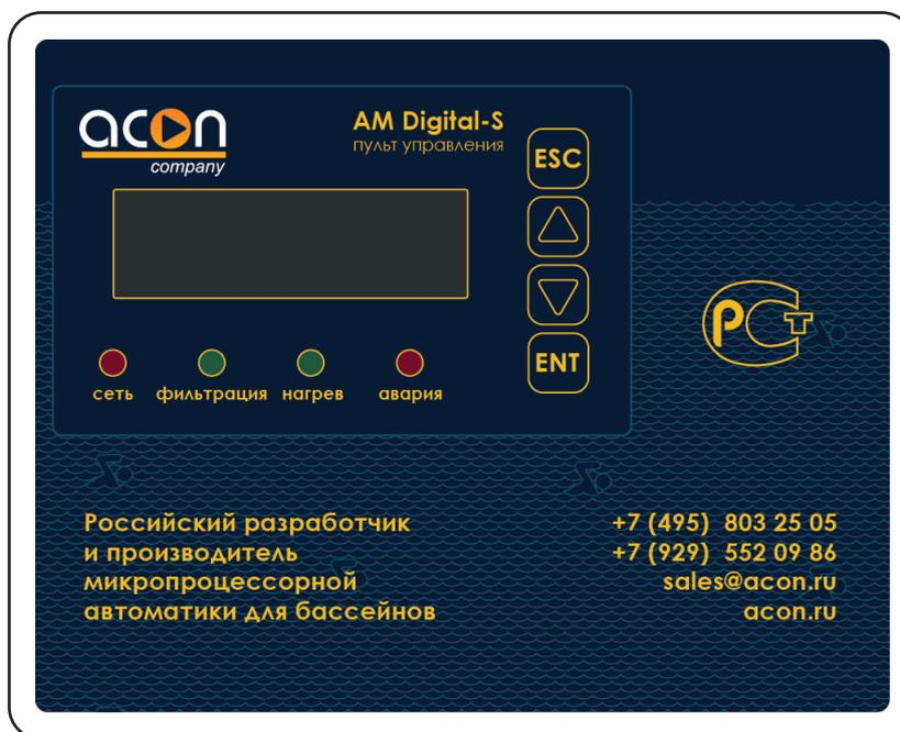
Рисунок 4. Панель управления AM Digital - S
