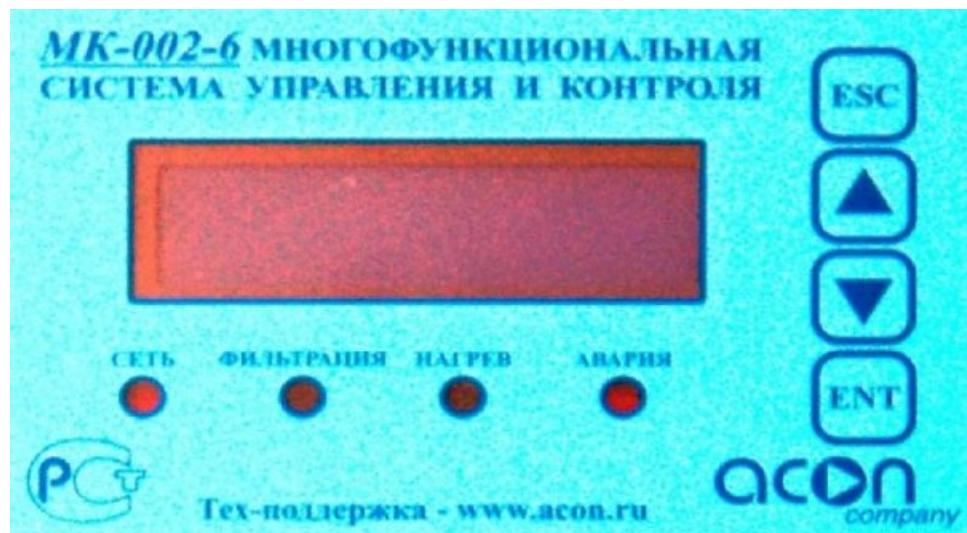
Двухстрочный жидкокристаллический дисплей для настройки и отображения рабочих и установочных параметров.
