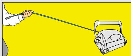
Кабель будет проворачиваться внутри кожуха и таким образом распутываться.
