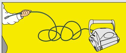
Расположите пылесос на земле и подключите к блоку питания. В одной руке держа E-Z вертлюг (вертлюжный механизм), отходите от пылесоса, оттягивая кабель на всю его длину.
