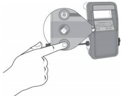
9. Роботизированный пылесос автоматически запустит выбранный цикл очистки, если не нажимать ни на какие кнопки на блоке питания в течение 10 секунд. Индикаторы питания, индикаторы выбранного режима цикла очистки и индикатор выбранного графика очистки будут непрерывно гореть в течение цикла очистки.
