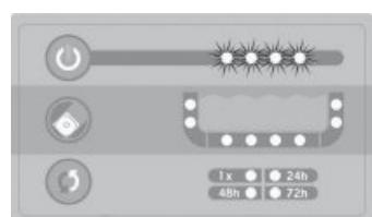
b. Перейдет в режим ожидания графика. Это означает, что блок питания находится во включенном состоянии между очистками в рамках графика. Индикаторы питания, индикаторы выбранного цикла и графика очистки будут медленно мигать. Роботизированный пылесос автоматически включится и запустит выбранный цикл согласно выбранному графику.
