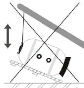
Используйте оба транспортировочных кольца для подъема фильтра из горизонтального в вертикальное положение
