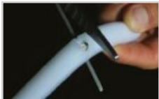
Отрежьте часть ленты необходимой длины, используя ножницы. Резать ленту можно только в обозначенных местах
