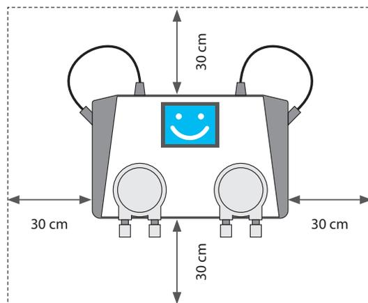
Разметьте и просверлите отверстия диаметром 8 мм и расстоянием друг от друга 23 см. Прикрепите станцию ASIN Aqua при помощи крепежа входящего в комплект.
