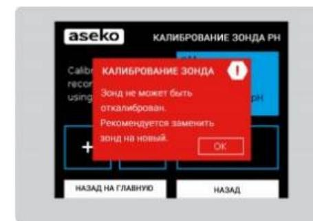
Данное предупреждение высвечивается в том случае, если показания pH находятся вне диапазона калибровки 6,2-7,8.
