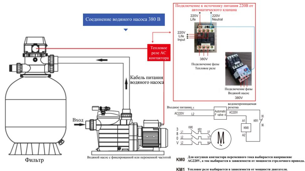
Для управления водяным насосом 380 В требуется комбинированная проводка из двух (2) электрических компонентов, контактора переменного тока и теплового реле.
