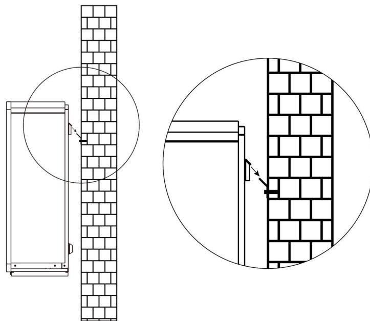
Подвесив оборудование на кронштейн осторожно опускайте его до тех пор, пока накладки снизу не упрутся в стену.
