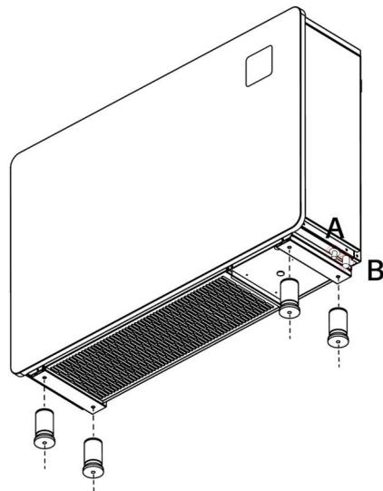
2. Подсоедините дренажную трубку и подключите шнур питания в соответствии со схемой кабелей.
