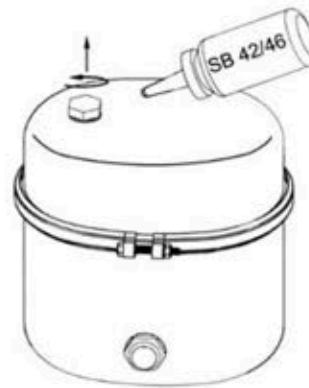
Ваш компрессор поставляется не заполненный маслом для безопасной транспортировки. Перед началом использования необходимо заполнить отсек масляного фильтра маслом до нужного уровня:
