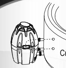
Снять стопорные пробки
