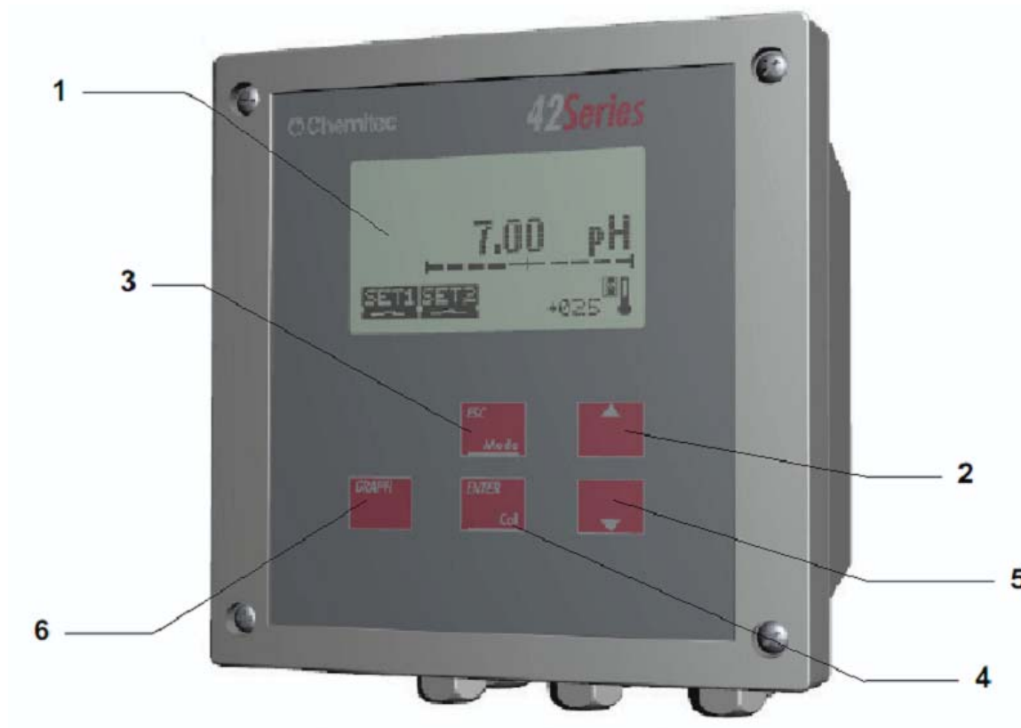
Рис. 2 – Блок управления в исполнении для настенной установки, передняя панель
