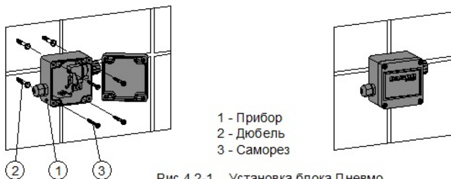
Рис.4.2-1 Установка блока Пневмо
