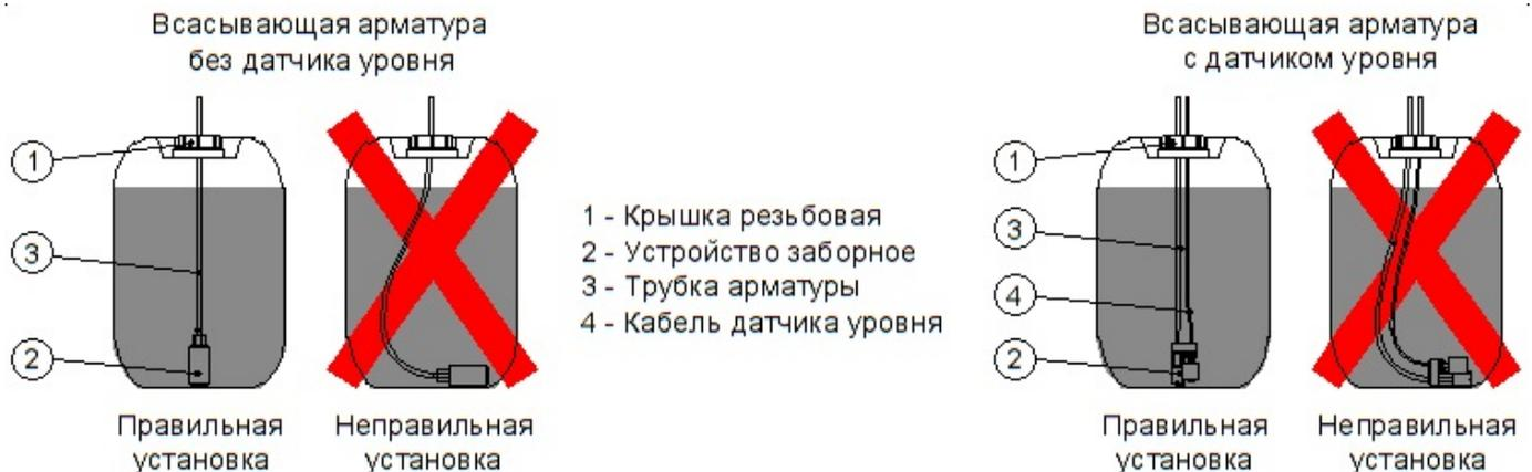
Рис.4.2-8 Установка всасывающей арматуры насоса в расходную канистру
