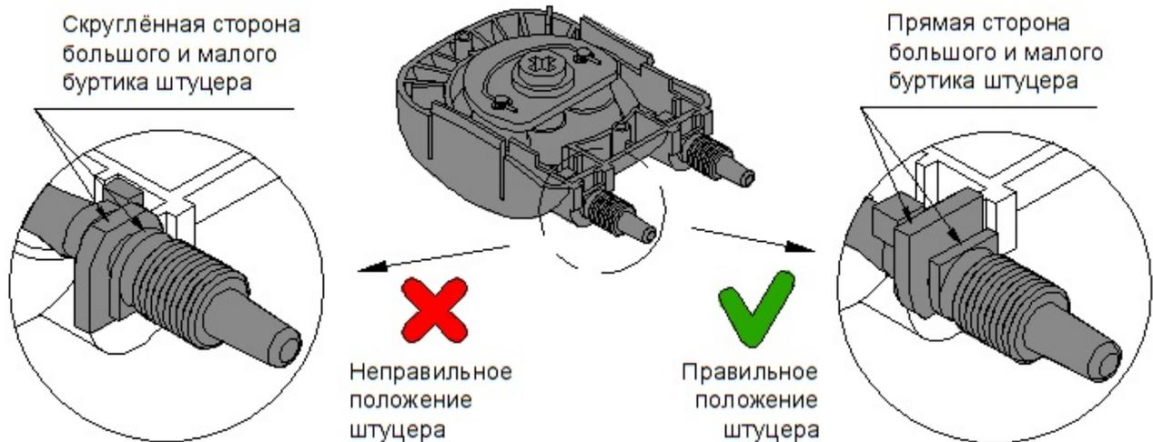
Рис. 4.2-3 Установка шланговой арматуры в перистальтический насос
