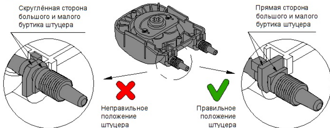
Рис.4.2-3 Установка шланговой арматуры в перистальтический насос
