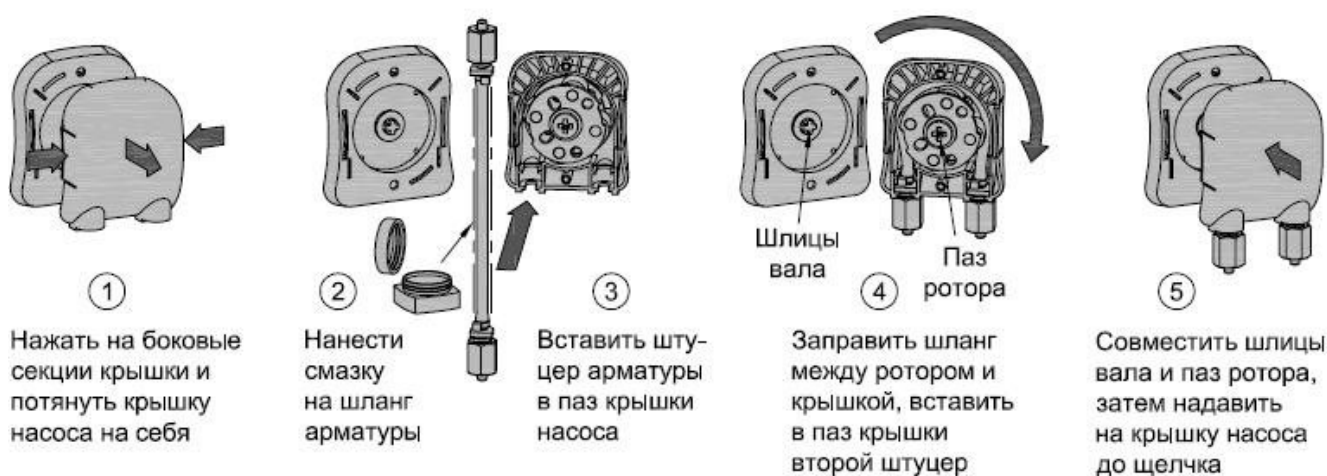
Рис.7 Установка шланговой арматуры в перистальтический насос
