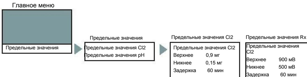
Для измерения хлора (Redox) и для измерения pH можно установить верхнее и нижнее предельные значения.
