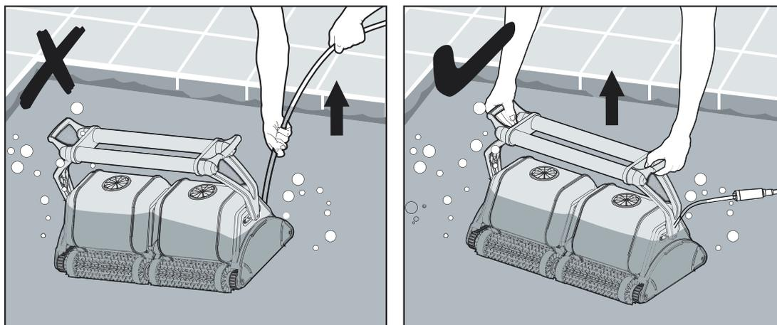
Используя плавающий кабель, подтяните робот к краю бассейна.
