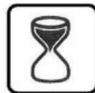
Датчик задержки таймера.
