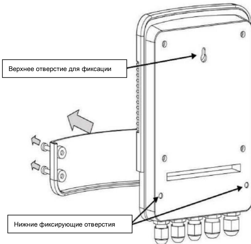
Задняя поверхность Pool Smart Plus имеет верхний крюк винта ключевого отверстия, расположенный сзади крышки, и 2 нижние отверстия для винтов, к которым получается доступ после снятия 4 винтов,держивающих нижнюю крышку доступа спереди.
