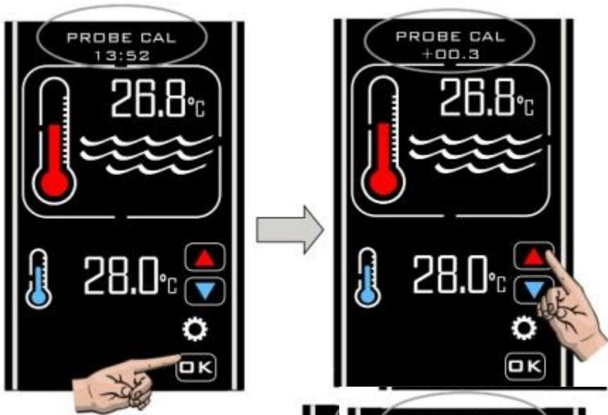
Калибровка датчика обычно не нужна. Однако, если вам потребуется сделать регулировку, замеряйте значение температуры воды в бассейне точным термометром и затем отрегулируйте по необходимости.
