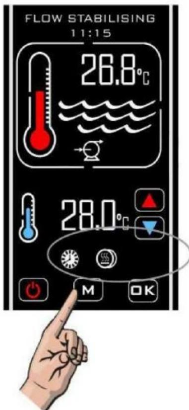
В этом режиме регулятор будет нагревать, когда он получает поток во время периода включенного времени и «Приоритет нагревания» будет выполняться, когда таймер «Выключен».
