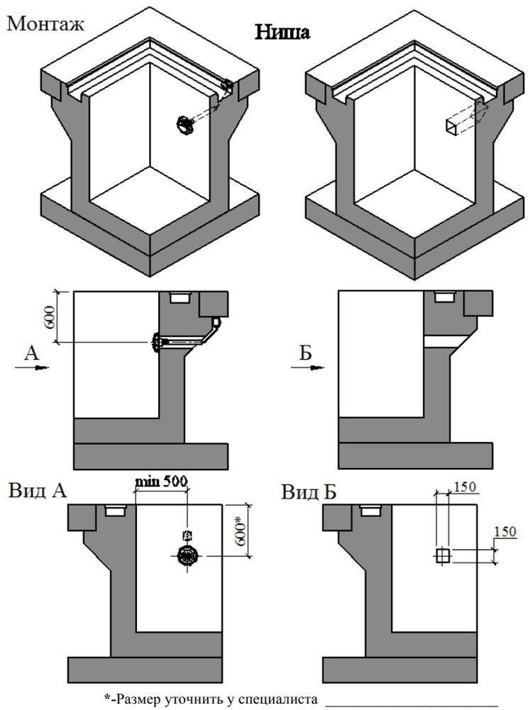
Рисунок 4 (Установка в скиммерный бассейн)
