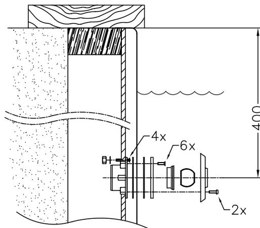
для бассейнов, стены которых изготовлены из строительных блоков
