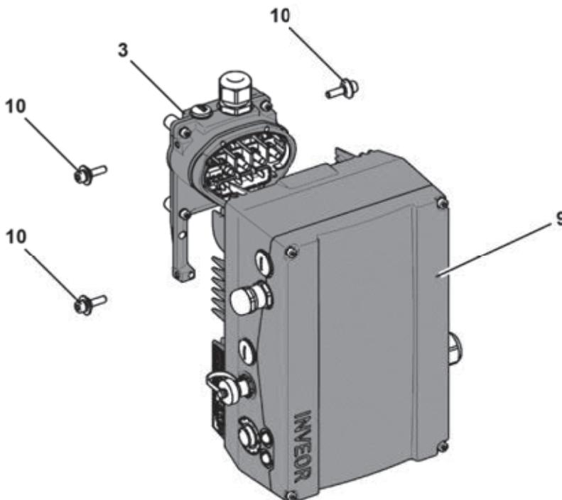
**Placing the drive controller / Размещение контроллера привода**
