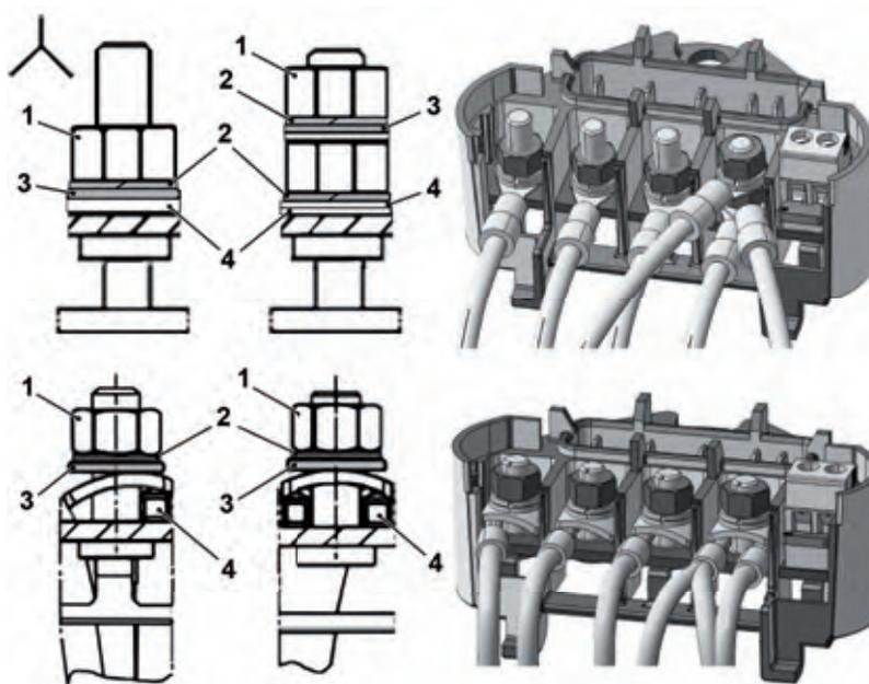
1. Nut / Гайка  $M_A = 5 \text{ Нм}$
