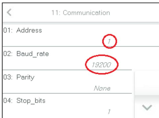
5. Проверьте адрес и скорость передачи.
