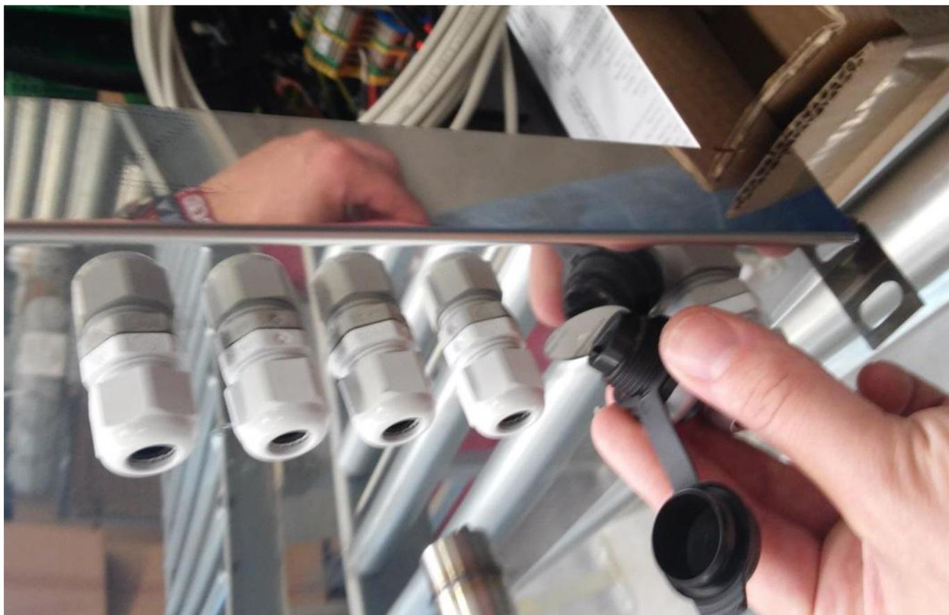
Подключите фишку RJ45 кабеля к черному разъему (RJ45).
