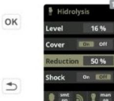
1.2 Cover: подключение автоматического покрытия.
