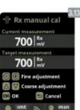
3.8 Не доставая датчик из воды, используйте кнопки + / - для регулировки показаний, чтобы она соответствовала эталонным значениям. (фотометр или других измерений).
