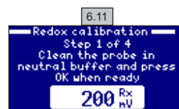
6.11 Пример первого этапа калибровки с помощью буферного раствора. Выполните все 4 этапа.
