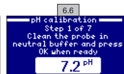
6.6 Пример первого этапа калибровки с помощью буферных растворов. Выполните все 7 этапов.
