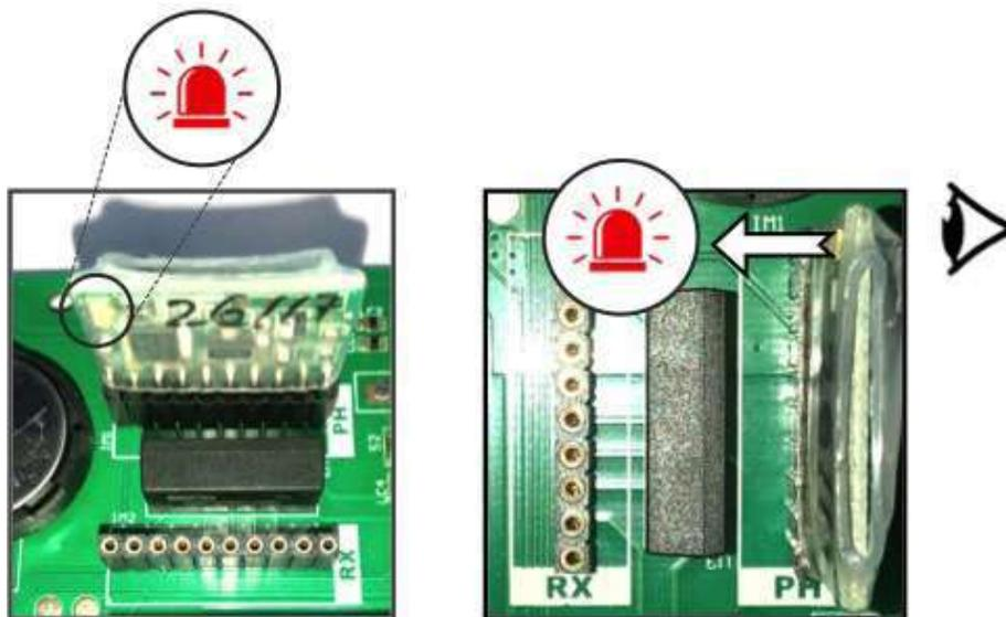
**Подключение ячейки к устройству**
