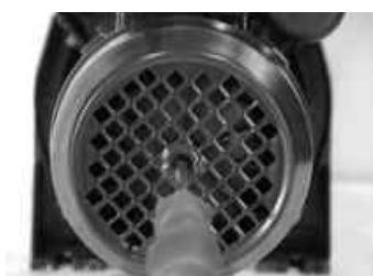
С целью предотвращений блокировки механического запора, перед запуском или после продолжительное неизпользование насоса повернуть ось через вентиляторю.
