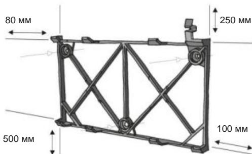
Примечание: крепежные винты и заглушки прилагаются. Отверстия должны иметь диаметр 8 мм.
