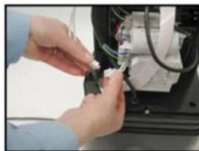
4. Отсоедините лампу от сетевой розетки, размещенной на задней стенке генератора.
