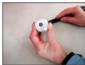
10. Отшлифуйте волокна тонкой наждачной бумагой, если они получили повреждения во время резки.
