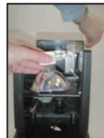
6. Замените лампу, подключите новую лампу к цепи питания прибора и установите на место винт крепления.
