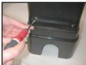
2. Отверните 3 винта крепления крышки, два спереди и один сзади.
