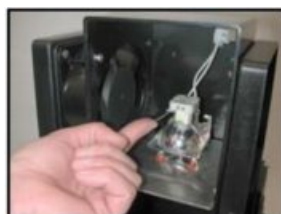
4. Переместите вверх рычажок держателя лампы, чтобы лампа вышла наружу из втулки держателя.
