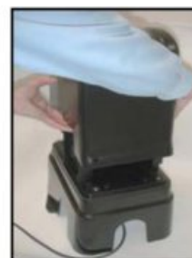
3. Поднимите крышку для замены лампы.
