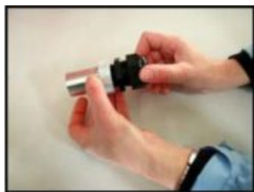
5. Наверните на корпус оптического порта кабельный зажим.
