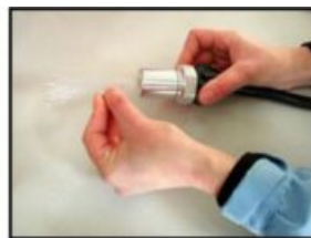
7. Затяните волокна кабельным зажимом и продерните их на всю длину, так чтобы они равномерно заполнили все пространство порта.
