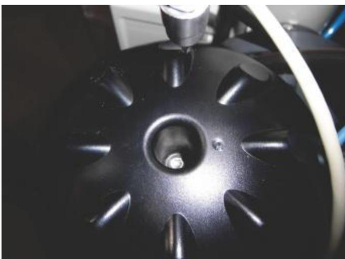
Рисунок 196: Извлечение крепежного винта верхней крышки
