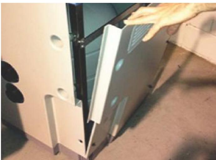
Рисунок 30: Снятие боковой панели
