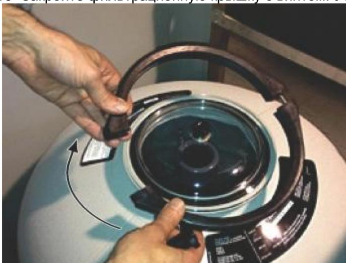
Рисунок 28: Закрытие фильтрационной крышки
