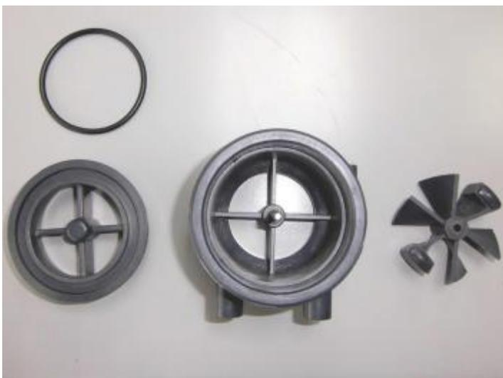
Рисунок 174: Детали турбины потокового датчика
