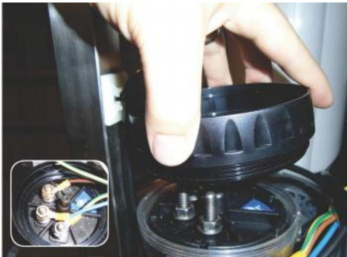
Рисунок 197: Снимите верхнюю крышку
