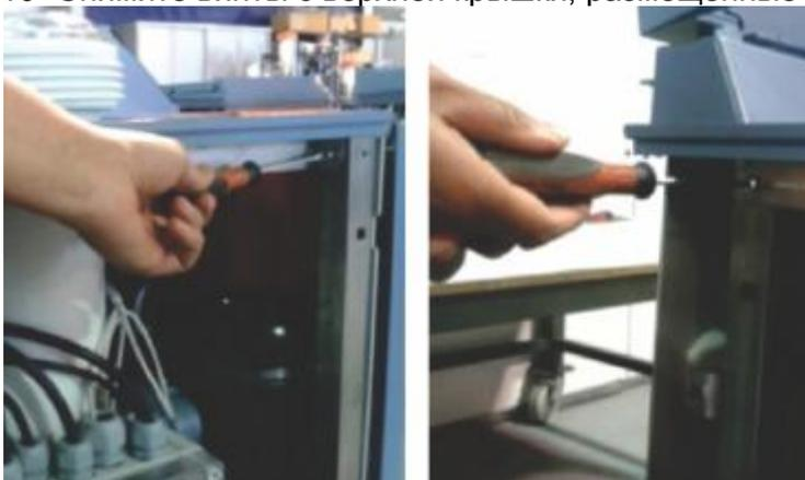
Рисунок 74: Винты верхней крышки
