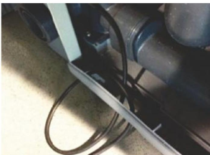
Рисунок 59: Протягивание кабеля через отверстия
