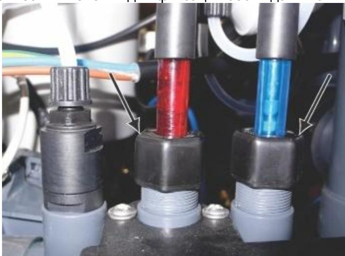
Рисунок 69: Затягивание гаек
