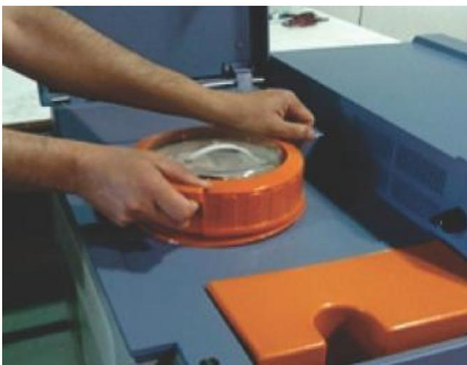
Рисунок 71: Снимите крышку фильтра предварительной очистки
