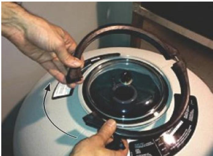
Рисунок 52: Закрытие фильтрационной крышки
