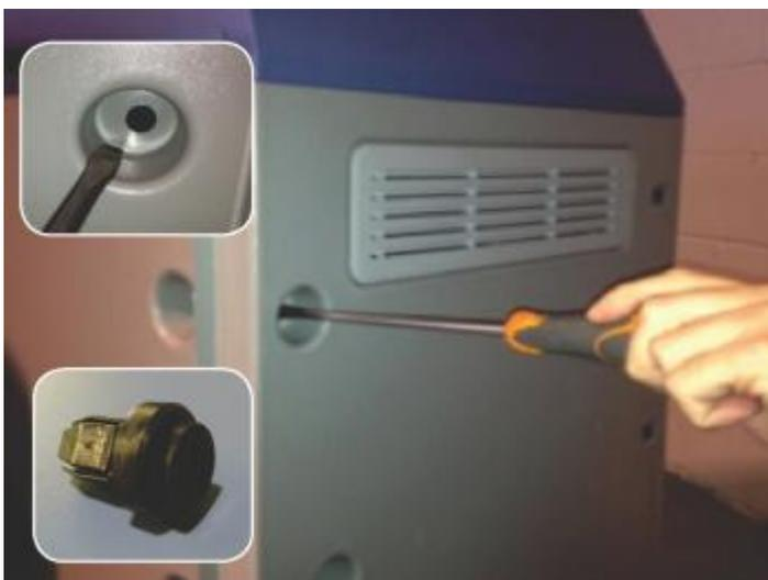
Рисунок 12: Откручивание винтов с боковой панели
