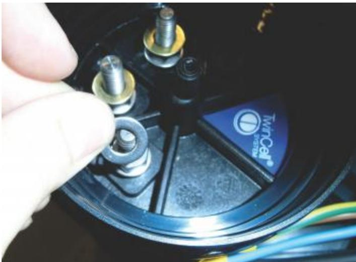
Рисунок 200: Установка новых гаек и шайб
