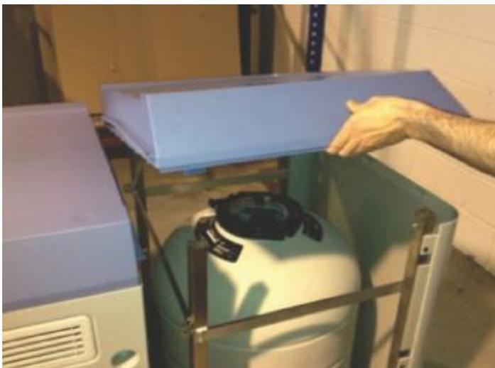
Рисунок 34: Снятие верхней крышки
