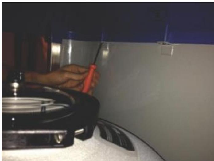
Рисунок 16: Отвинчивание одного из трех винтов на верхней крышке
