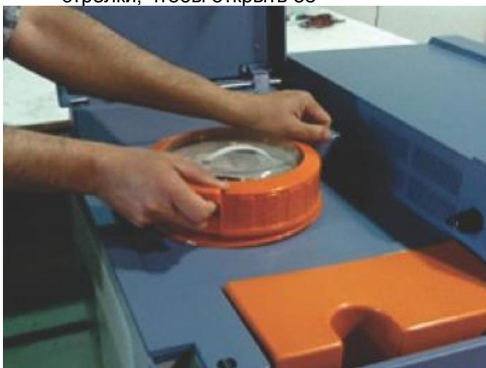
Рисунок 202: Снимите крышку фильтра предварительной очистки
