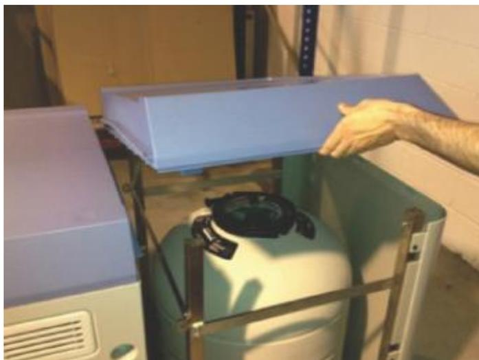
Рисунок 17: Снятие верхней крышки
