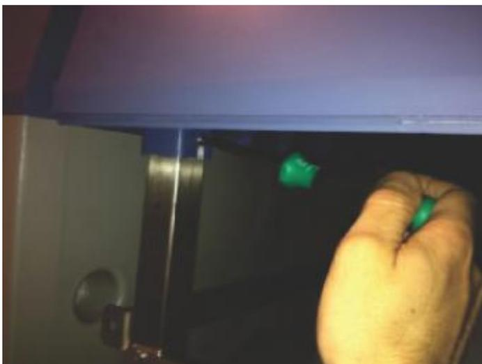
Рисунок 15: Отвинчивание одного из четырех винтов на раме фильтрационного модуля
