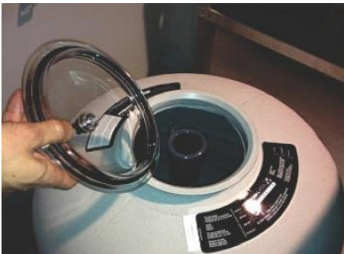
Рисунок 26: Снятие фильтрационной крышки
