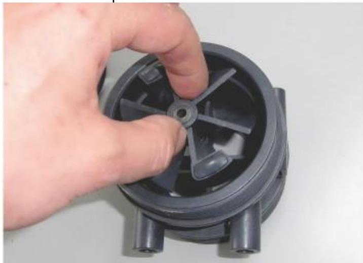
Рисунок 173: Крыльчатка турбины потокового датчика
