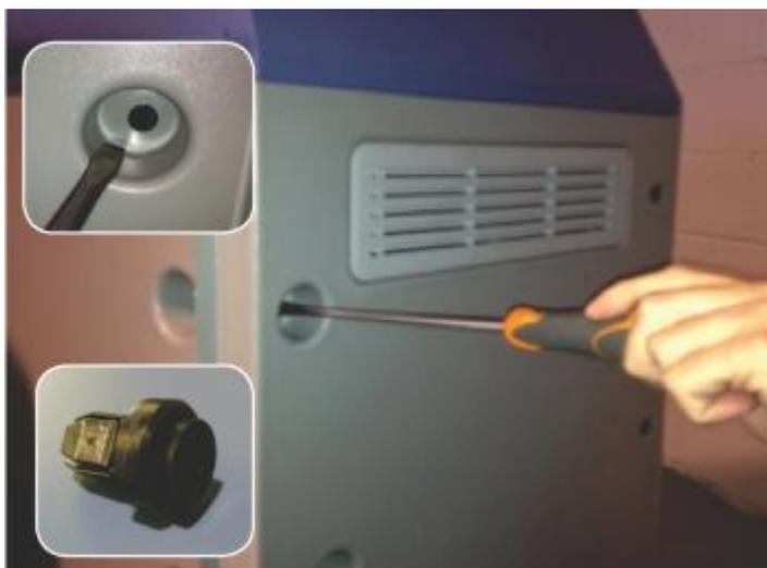
Рисунок 29: Отвинчивание винтов с боковой панели
