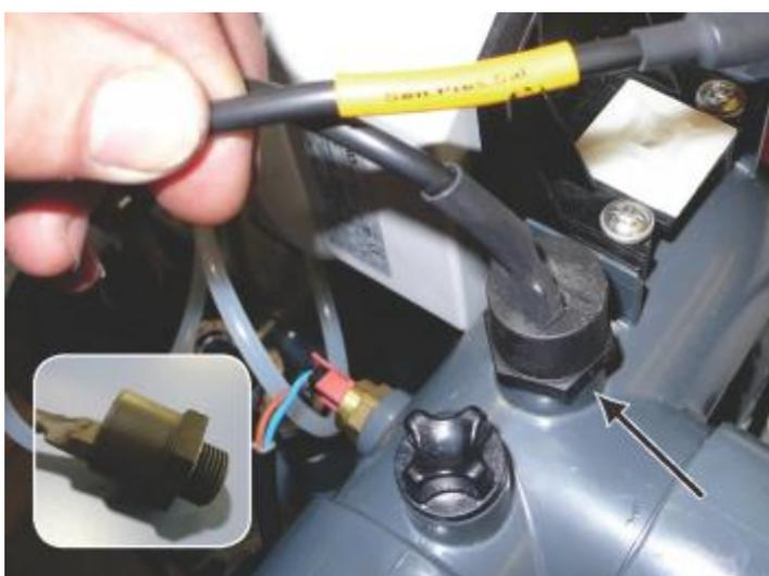
Рисунок 165: Датчик выпускного давления воды
