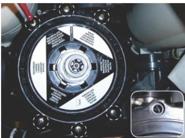
Рисунок 183: Закройте крышку многопроходного клапана
