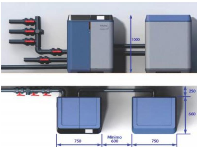
Рисунок 5: Независимый блок AstralPool MAC и фильтрационного модуля detached
