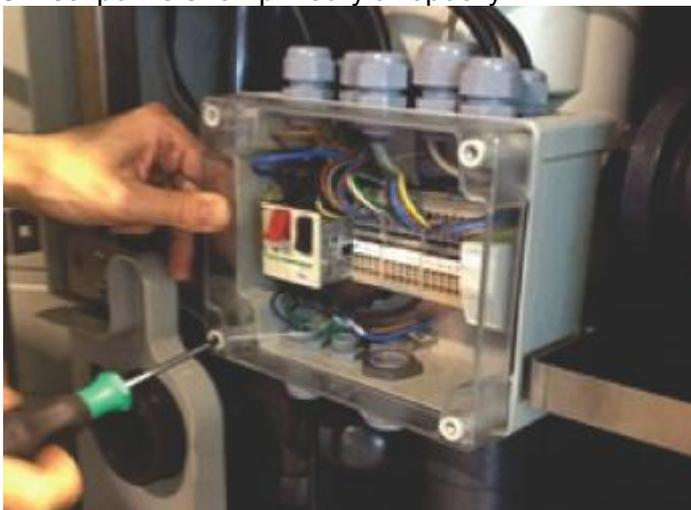
Рисунок 63: Закрытие электрической коробки
