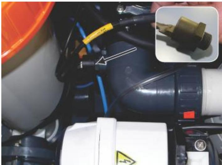
Рисунок 164: Датчик выпускного давления воды
