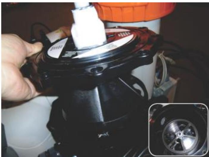
Рисунок 182: Крышка и корпус многопроходного клапана
