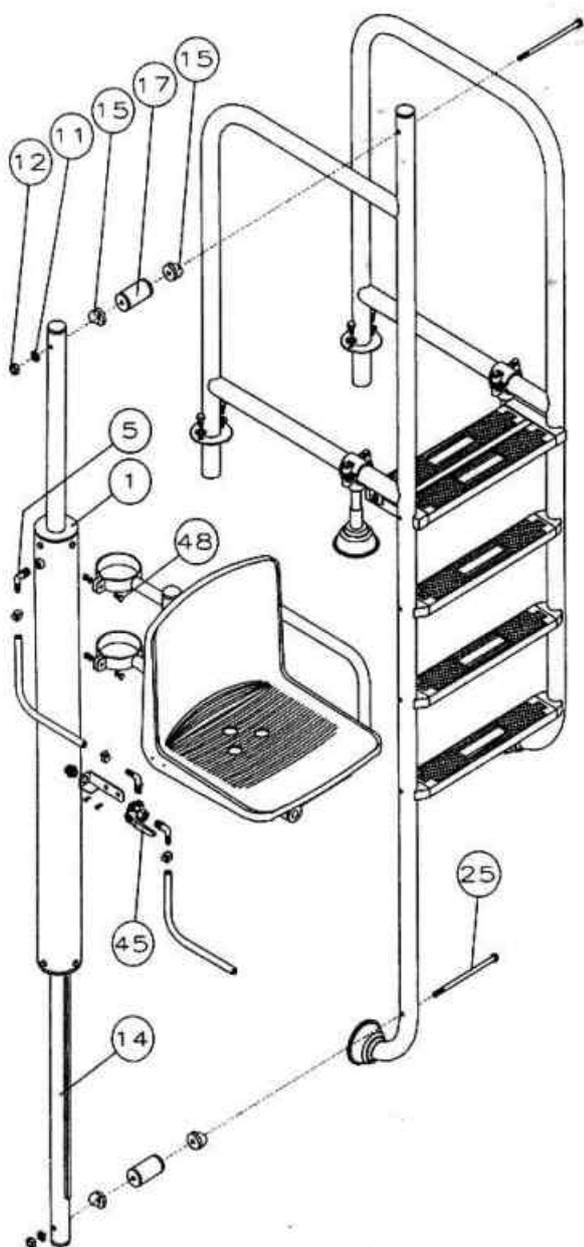
3.9 - Подайте на распределительный кран (45) воду из водопроводной линии и установите ручку распределительного крана в такое положение, чтобы стул поднялся вверх. Изменяя положение ручки распределительного крана, проверьте поднятие и опускание стула.
