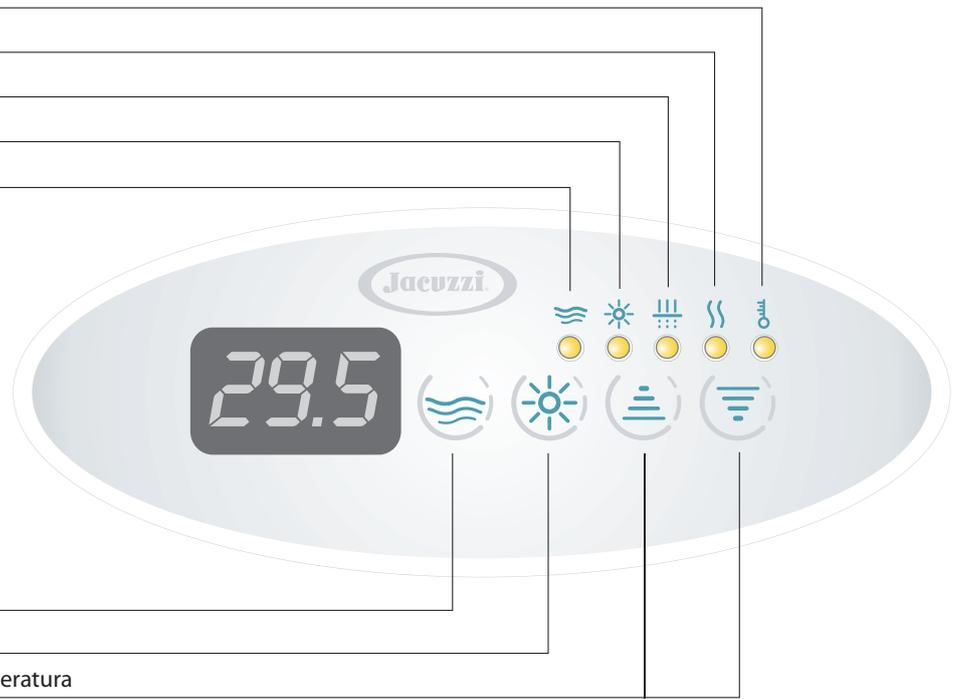
► Pulse los botones “” o “” para introducir la duración deseada (entre un mínimo de 4 y un máximo de 12 horas).
