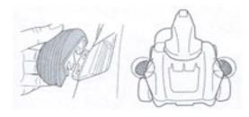
Если робот имеет тенденцию оставаться дольше в некоторых зонах квадратного или узкого прямоугольного бассейна, размещение бампера спереди и сзади пылесоса устранит этот шаблон.
