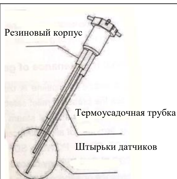
Рисунок 6 Схема датчика уровня воды
