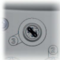
Рисунок 19 — Резиновая перемычка в соединительном гнезде 3
