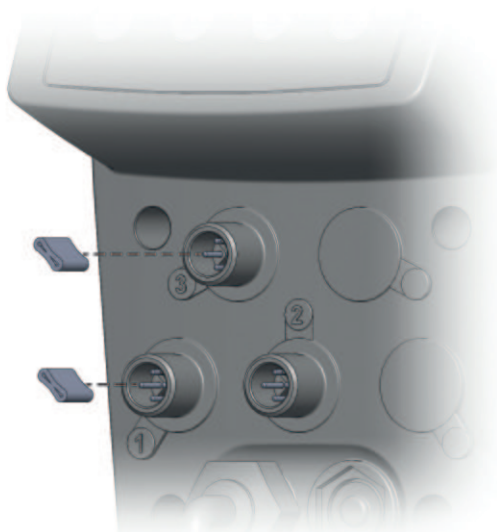
Рисунок 16 — Резиновые перемычки в гнездах 1 и 3 насоса-дозатора MAGDOS LA/LD
