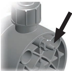
Рис. 36: Система удаления воздуха из дозирующей головки с винтом для выпуска воздуха
