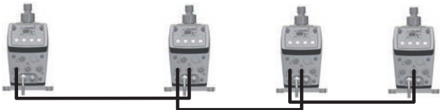
Рис. 17: Синхронизация нескольких насосов-дозаторов с помощью обратной связи хода и импульсного управления
