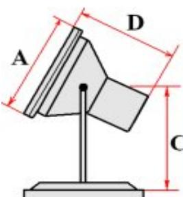
При загрязнении светильника его следует протереть сухой или слегка влажной мягкой тканью. Не допускается применение растворителей, других агрессивных моющих и абразивных средств. Монтаж, демонтаж и обслуживание светильника должны проводиться в светлое время суток при отключенном электропитании. Светильник подключается к источнику питания или к контроллеру. При отклонении рабочего напряжения от допустимого заявленного как в большую, так и меньшую сторону светильник может выйти из строя.
