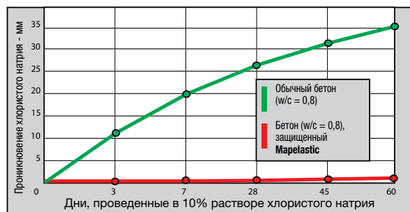
Рис. 3: Защита Mapelastic пористого бетона от проникновения хлористого натрия
