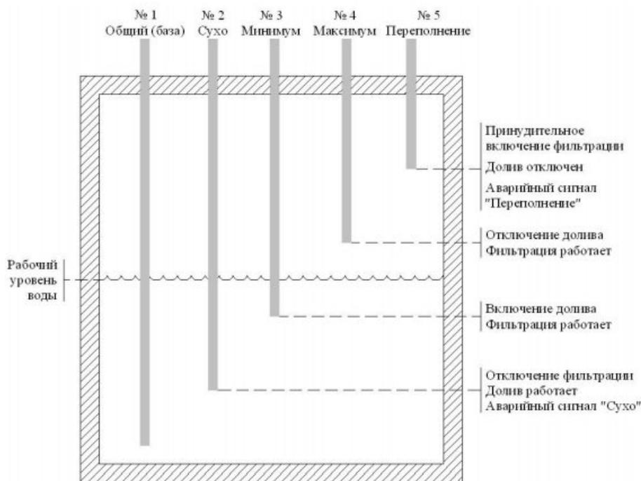
Для бассейна **скиммерного типа**, используются клеммы: №№ 1,2,3 в зависимости от заданного в пункте 6.4.4.7. типа используемого датчика уровня воды.
