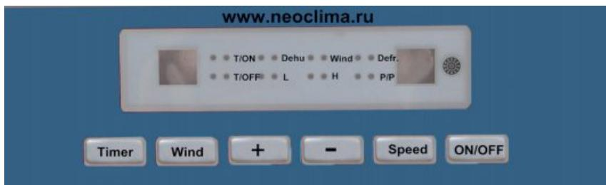
Экран отображает текущий уровень влажности, температуру, заданный уровень влажности и показания таймера.
