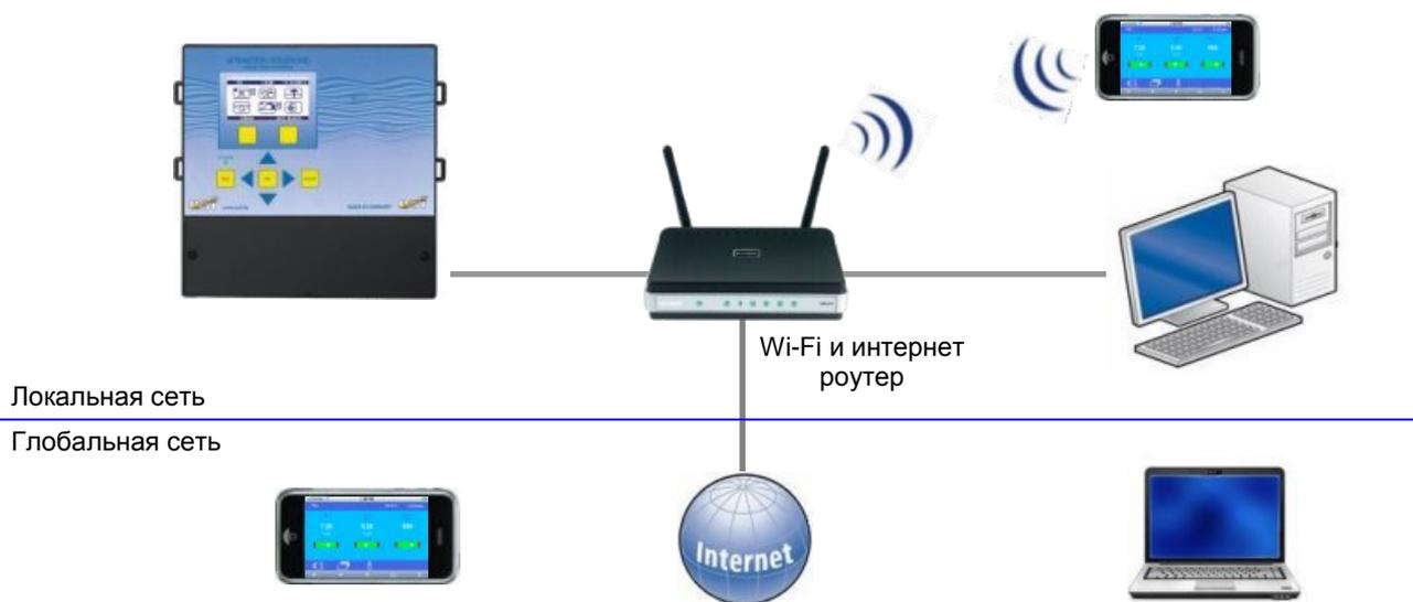
Для соединений необходимо использовать стандартный Ethernet сетевой кабель. После успешного соединения кабелей и подачи питания в левом верхнем углу дисплея отобразится символ LAN. Имеющееся соединение позволяет получить удаленный доступ к устройству в рамках локальной сети (смотри рисунок выше).
