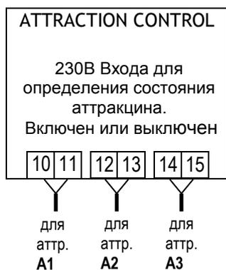
Входа 230В используются для определения текущего состояния аттракциона, если этот аттракцион управляется импульсами. (См раздел конфигурация выходов). Входа находятся на достаточном расстоянии между собой, что позволяет для определения состояния использовать любую фазу электропитания аттракциона.
