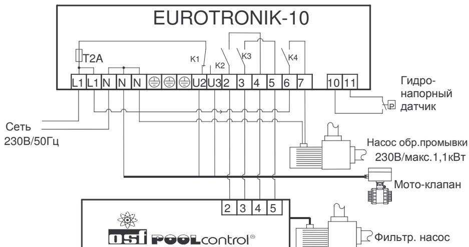
Соединение между EUROTRONIK-10 и блоком серии PC ограничивается прокладкой 4х жильного кабеля. Фильтрационный насос, нагреватель и дозирующее устройства остаются присоединенными при этом непосредственно к блоку управления фильтрацией. Контакт K3 блока EUROTRONIK отключают фильтрационный насос, если клапан меняет позицию. Контакт K2 принудительно включает фильтрующий насос на время процесса обратной промывки даже вне цикла фильтрации.
