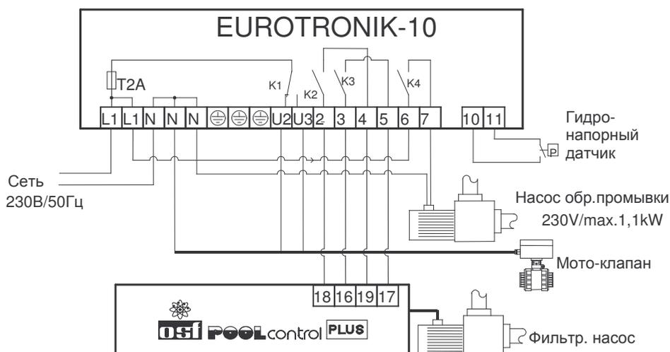
Соединение между EUROTRONIK-10 и блоком серии PCP ограничивается прокладкой 4х жильного кабеля. Фильтрационный насос, нагреватель и дозирующее устройства остаются присоединенными при этом непосредственно к блоку управления фильтрацией. Контакт К3 блока EUROTRONIK отключают фильтрационный насос, если клапан меняет позицию. Контакт К2 принудительно включает фильтрующий насос на время процесса обратной промывки даже вне цикла фильтрации.
