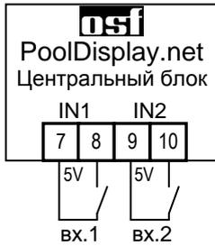
Цифровой вход может использоваться для подключения к выходам тревожной сигнализации дозирующего или другого оборудования, а также для подключения внешней кнопки. Подробнее в меню конфигурация дополнительных функций.
