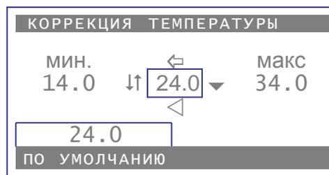
На экране над кнопкой «ПО УМОЛЧАНИЮ» отображается температура измеренная датчиком, минимальное и максимальное значение отличаются на 10 градусов. Для ввода коррекции достаточно установить действительную температуру воды бассейна.
