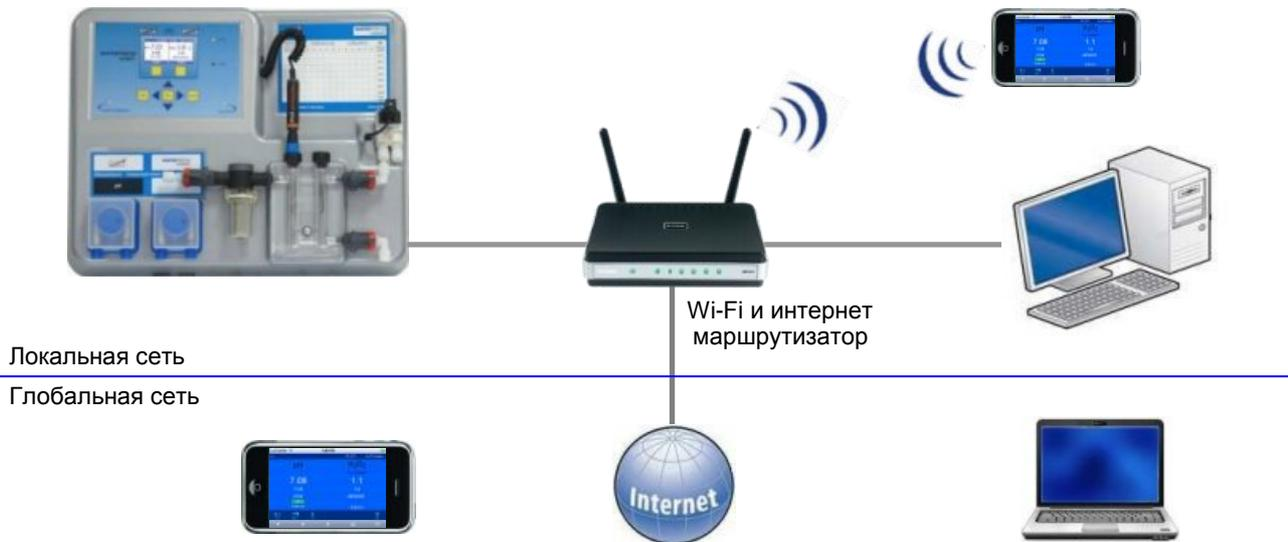
Для соединений необходимо использовать стандартный Ethernet сетевой кабель. После успешного соединения кабелей и подачи питания в левом верхнем углу дисплея отобразится символ LAN.
