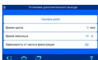
Часовое реле определяет времена работы доп. выхода.
