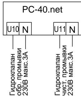
К клемме U10 и N можно подключить штанговый гидроклапан (230В) для проведения обратной промывки.
