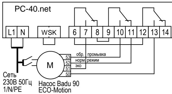
В настройках на самом насосе нужно активировать внешнее управление фиксированными скоростями „Festdrehzahlen digital“ со «статичным» типом сигнала «Dauersignal». Для скоростей N1, N2 и N3 необходимо выбрать желаемые скорости эко-режима, нормального режима и для обратной промывки.
