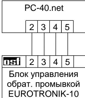
Для подключения блока управления обратной промывкой EUROTRONIK-10 требуется 4-х жильный кабель. При подключении нельзя перепутать провода. Блок EUROTRONIK-10 требует отдельного подключения к электросети
