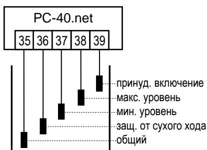
б) **Защита фильтрующего насоса от сухого хода.** Если уровень воды из-за промывки фильтров упадет ниже электрода «Защита от сухого хода» (клемма 36), то блок управления отключит фильтрующий насос, во избежание выхода его из строя из-за работы с недостаточным количеством воды. Насос будет отключен до тех пор, пока уровень воды в переливной ёмкости не достигнет электрода «мин.» (клемма 37).
