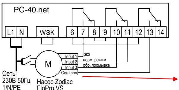
В насосе Zodiac FloPro VS регулирование скоростью подсоединяется к для этого предназначенным клеммам на обратной стороне пульта управления. Для всех режимов нужно определить желаемую скорость. Эко-режим (Input 1), нормальный режим (Input 2) и режим обратной промывки (Input 3)
