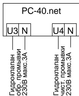
К клемме U3 и N можно подключить штанговый гидроклапан (230В) для проведения обратной промывки.
