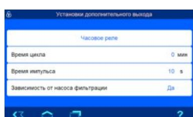
Часовое реле определяет времена работы доп. выхода.
