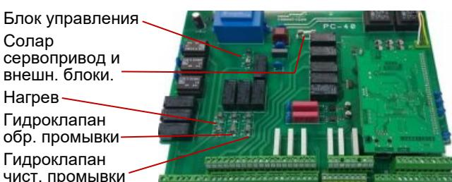
Электронная часть защищена плавким предохранителем (0,5A) находящимся на плате внутри блока управления. Выходы для нагрева, клапанов обратной и чистовой промывки и для солара защищены предохранителями 3,15A.
