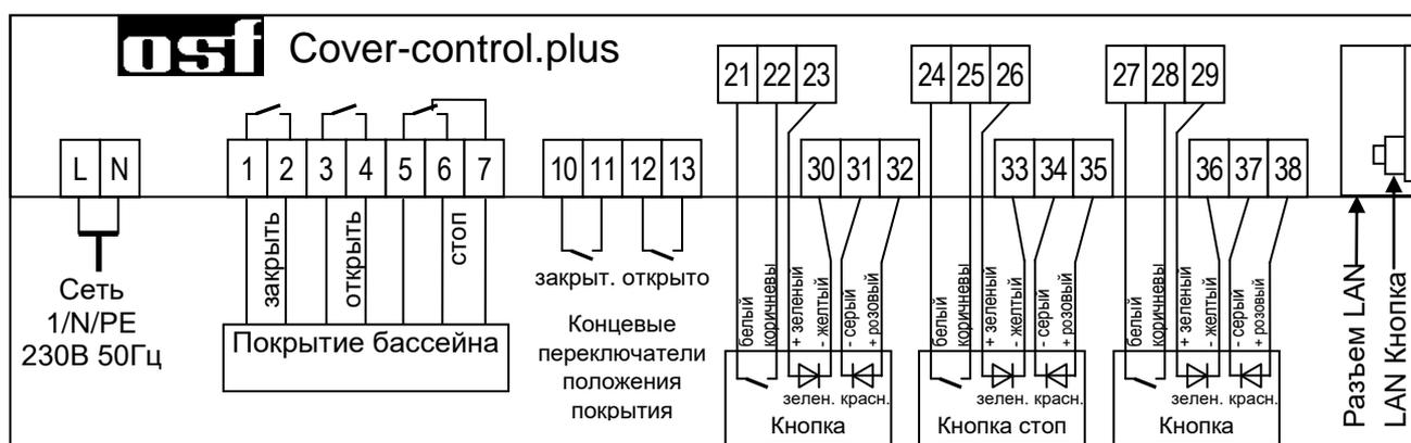
**Провода с низким напряжением нельзя укладывать в один кабельный канал вместе с силовыми кабелями. Принципиально избегать прокладки проводов с низким напряжением в непосредственной близости от линий электропередачи.**
