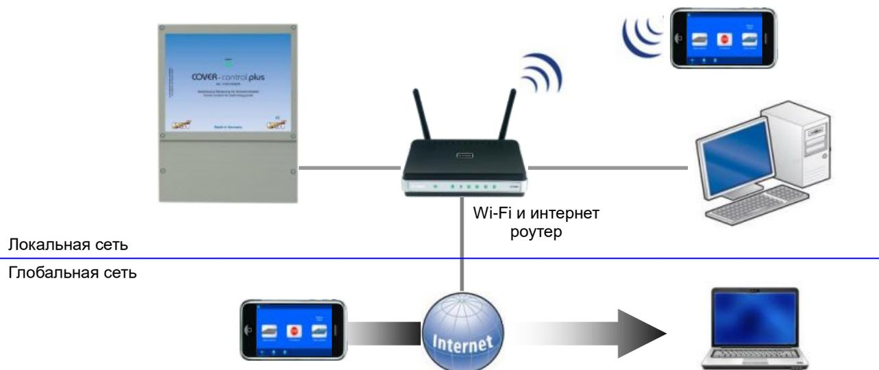
Для соединений необходимо использовать стандартный Ethernet сетевой кабель. Имеющееся соединение позволяет получить удаленный доступ к устройству.
