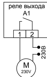
работает, пока замкнуто управляющее реле, и аттракцион выключен, если реле разомкнуто. На схеме справа приведен пример подключения аттракциона со статическим управлением.
