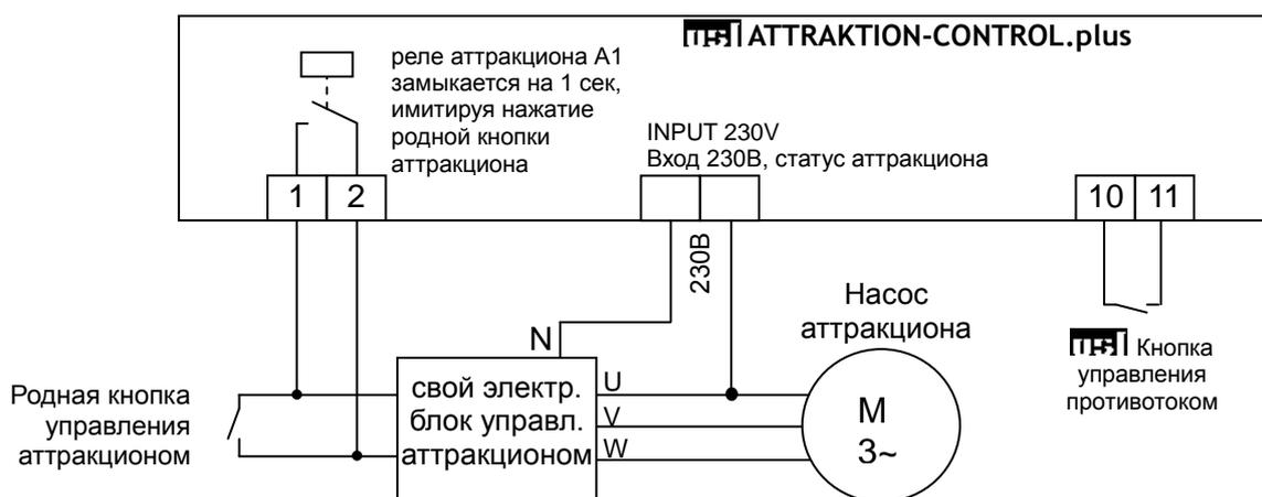
Чтобы блок, Attraction-control.plus, всегда знал о текущем состоянии аттракциона и правильно отображал на дисплее его состояние, необходимо вход 230В параллельно соединить с электропитанием исполнительного элемента аттракциона.
