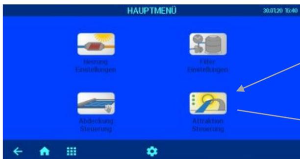
После логического соединения блоков Attraktion-control.plus с блоком PC-45 exclusiv в главном меню последнего появится дополнительная иконка, которая ведет в меню настроек и конфигурации блока управления аттракционами.
