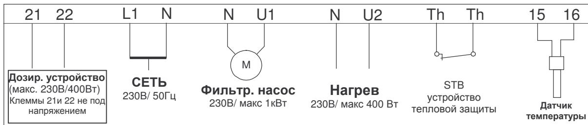
К контактам U2 и N можно вместо циркулирующего насоса теплоснабжения подсоединить дополнительный **osf** блок с возможностью непосредственного подключения к нему электрических нагревательных элементов. В ассортименте имеются дополнительные блоки мощностью 10,5 кВт (Арт.№: 3002000100), 18 кВт (Арт.№: 3002400100) и 30 кВт (Арт.№: 3002100100)
